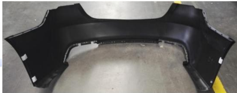
国産某车型（PP-BP3184） 产品壁厚：2.5mm減重 15%产品壁厚：2.0mm
